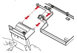
> Чтобы снять вставку для плоского шва для приставного столика, отожмите вниз фиксирующие точки и вытяните вставку для плоского шва для приставного столика из фиксирующего отверстия.
