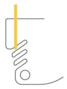
> Протяните нитку вокруг нитепритягивателя наверх и вытяните ее по соответственному ходу нитки в направлении иглы.
