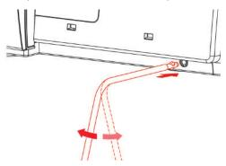
> Чтобы снять коленный рычаг, вытяните его из разъема коленного рычага, не наклоняя при этом коленный рычаг вбок.
