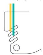
> Протяните нитку вокруг нитепритягивателя наверх и вытяните ее по соответственному ходу нитки в направлении иглы.
