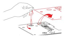
> Удалите пыль и обрезки ткани и ниток пинцетом или пылесосом.
