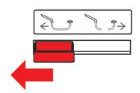
> Медленно вращайте маховик против часовой стрелки до тех пор, пока не соединятся трубки пневмозаправки.
