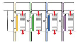
> Чтобы ослабить натяжение нитки, вращайте регулятор натяжения соответствующей нитки к более низкому значению.
