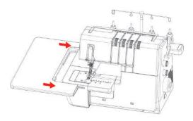
> Чтобы снять приставной столик, нажмите на кнопку разблокировки (1) приставного столика и вытяните его влево.
