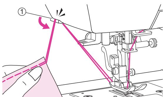
9. Протяните обе нити за блок иглы к отрезному устройству и обрежьте их.
