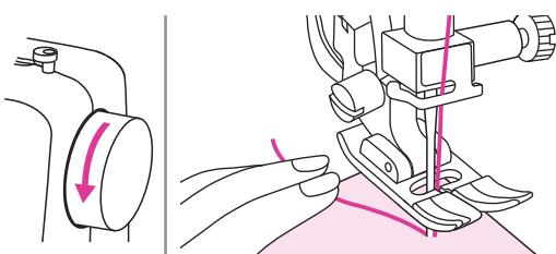
5. Поверните маховик на себя (против часовой стрелки) для того, чтобы опустить иглу в ткань.
