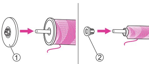
3. Наденьте катушку ниток и колпачок соответствующего размера на катушкодержатель.
