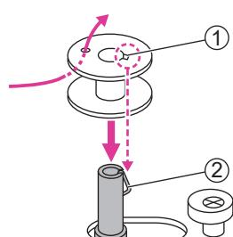
5. Проденьте кончик нити в отверстие шпульки по направлению изнутри - наружу и вставьте шпульку в намоточный стержень так, чтобы желобок на шпульке совпадал с рычажком на стержне, как показано на рисунке.
