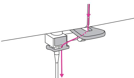
9. Заправьте нить за плоскую горизонтальную направляющую нити справа и затем - ниже слева. Теперь заправьте нить в иглу, используя устройство для заправки нити.
