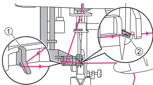
12. Протяните нить слева направо вокруг нитенаправителя нитевдевающего устройства, затем протягивая нить спереди иглы зацепите ее за проволочный крючок напротив иглы позади нее.
