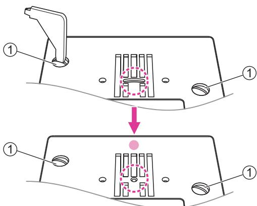
Открутите шурупы, крепящие игольную пластину и снимите пластину.
