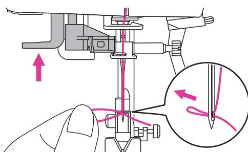
14. Поднимите рычаг нитезправщика - проволочный крючок повернет нить и сформирует петлю. Потяните за петлю, чтобы распрямить нить и завершить ее заправку.
