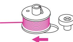
8. После того как, нитка закреплена несколькими намотанными слоями, остановите машину и обрежьте кончик нитки, который вы придерживали. Затем продолжайте намотку до заполнения шпульки, когда нитка намотается на шпульку в достаточном количестве, скорость намотки уменьшится. Остановите машину и переведите намотчик в левое положение.
