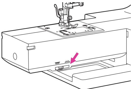
Переключатель зубчатой рейки расположен снизу на фронтальной части рукавной платформы.
