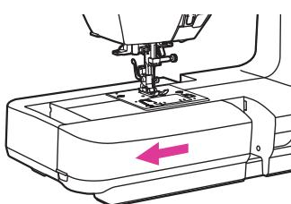
Снимите швейный столик с машинки сдвинув его влево.
