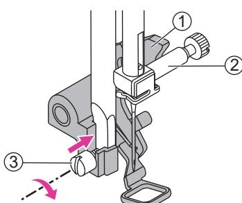
Рычажок вышивальной лапки должен упираться в винт закрепления иглы сзади. Затяните винт, крепящий лапку, отверткой.
