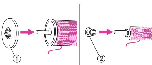
1. Установите катушку ниток на катушкодержатель, оденьте колпачок. Для лучшего качества шитья используйте колпачок, соответствующий по размеру катушке ниток.
