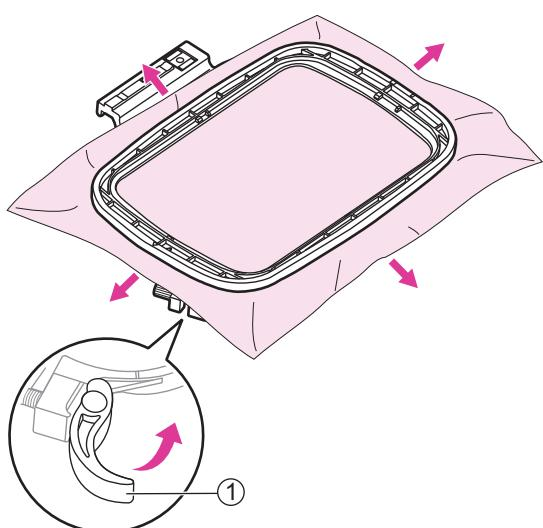
Положите ткань на наружную рамку, прижмите ее тщательно внутренней рамкой, затем расправьте ткань (см рисунок) и защелкните рычаг.
