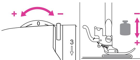
Регулятор давления лапки расположен наверху левой части машины.
