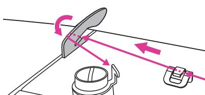
3. Пропустите нить под 2-м рычагом направляющей нити, а затем - за регулятор предварительного натяжения.
