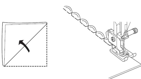
Используйте тонкую ткань (трикотаж, например). Сделайте складку и строчите по кромке. Шейте так, чтобы игла соскальзывала со сложенного края ткани. Может понадобиться немного увеличить натяжение нити иглы.
