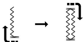
Сначала машина прошьет нижнюю поперечину и левый ряд.
