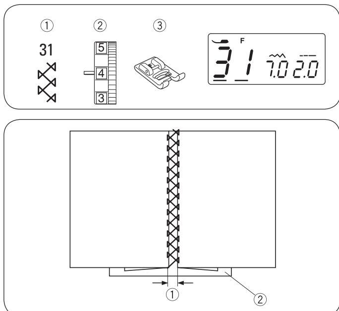
Эта строчка используется для соединения двух деталей изделия с эффектом разрыва в качестве декоративной отделки.
