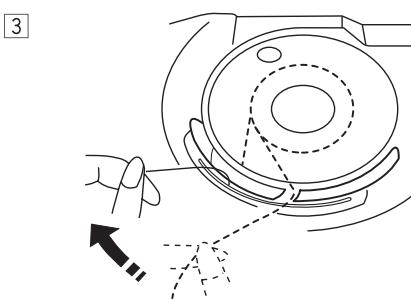
3 Потяните нить влево так, чтобы она прошла между пружинами натяжения.
