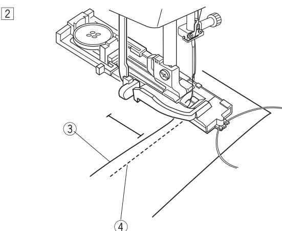
2 Запустите машину и обработайте петлю. Обе стороны петли и закрепки прошиваются поверх вкладной нити. Выньте изделие из машины и обрежьте верхнюю и нижнюю нитки.
