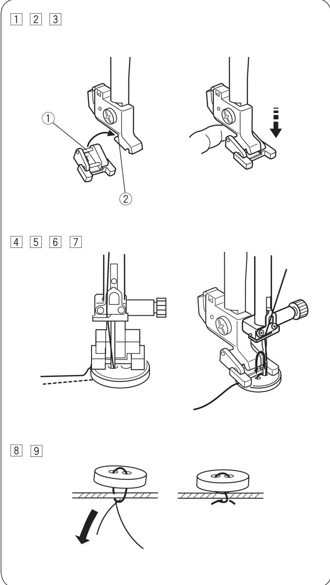
1 Опустите рейку двигателя ткани. Установите регулятор скорости на низкую скорость.
