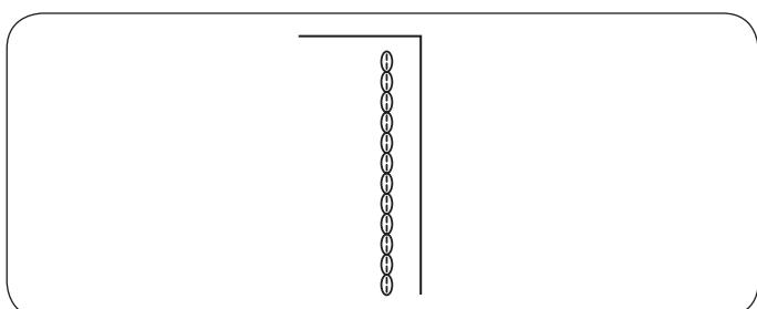
Строчка внакидку выполняется одним прямым стежком, двумя обратными стежками и четвертым прямым стежком. Строчка внакидку имитирует ручную работу при отстрочке костюмов, пиджаком, свитеров и джинсовой одежды.
