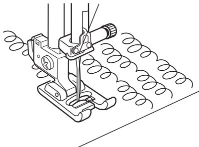
Предварительно запрограммированная строчка свободно-ходовой машинной стежки — быстрая и простая возможность простегать небольшие изделия.
