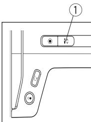
Поднимите прижимную лапку. Нажмите кнопку позиционирования иглы ①, чтобы поставить рычаг нитепрятгивателя в крайнее верхнее положение.
