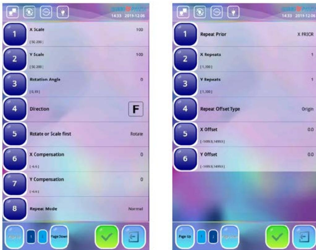
(1) (2) **Масштабирование по оси ХУ:** Этот параметр отвечает за коэффициент масштабирования модели вышивки в направлении X (по горизонтали) и направлении Y (по вертикали) и увеличение/уменьшение модели вышивки в процентном отношении.
