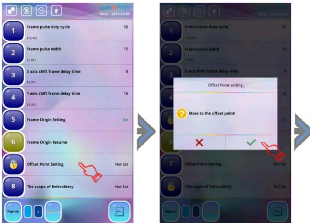
5. После установки точки смещения, система вернется в предыдущий интерфейс, и в пункте «Offset point setting/Настройка точки смещения» появляется опция «Set/Задать», вернитесь в главный операционный интерфейс и нажмите на иконку «Start/Пуск», чтобы начать процесс вышивки. Пальцы совершат перемещение от точки смещения к начальной точке модели вышивки в автоматическом режиме, после чего система начнет процесс стандартной вышивки.
