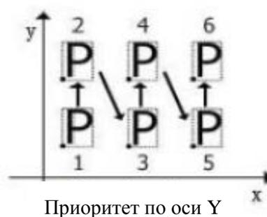
**Частичный повтор:** В режиме повтора вышивки, после вышивки определенного цвета модели, пальцы перемещаются в соответствующее положение следующей повторяющейся модели, и машина вышивает тот же самый цвет модели до тех пор, пока этот цвет не будет завершен, затем система переключается на следующий цвет и повторяет вышивку стежков каждого цвета.
