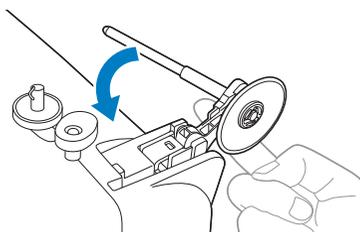
Зафиксируйте стержень для катушки на месте, повернув его до щелчка.
