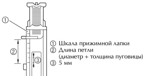
Пример. Для пуговицы диаметром 15 мм и толщиной 10 мм направляющую пластину пуговицы нужно установить по шкале на 25 мм.
