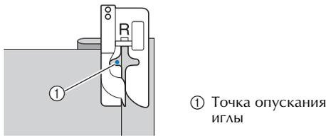
При изменении точки опускания иглы поднимите иглу, а затем измените ширину строчки.
