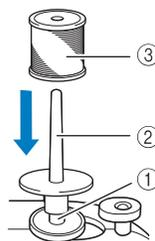
① Вал устройства намотки шпульки
