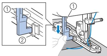
Рычажок для выметывания петель устанавливается за скобкой на лапке для обметывания петель.
