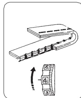
Регулировка натяжения верхней нити производится поворотом диска регулятора натяжения нити с цифрами.
