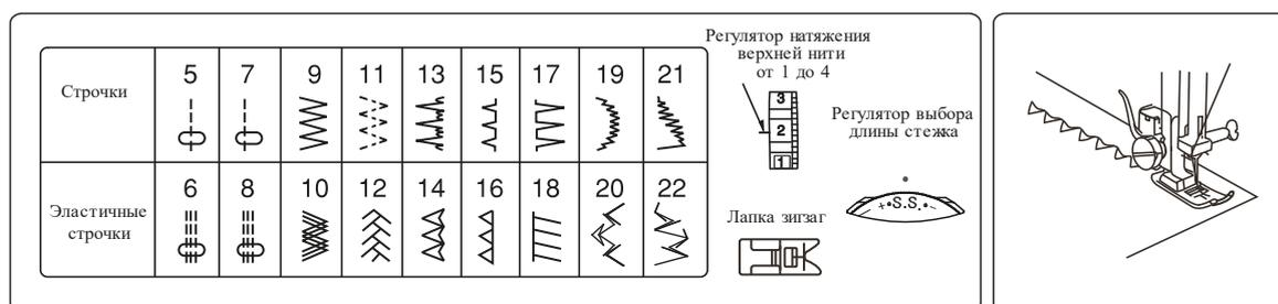
Эластичные строчки (в таблице строчки нижнего ряда), в основном, используются для работы с трикотажными и эластичными тканями. Регулятором выбора строчки установите необходимую строчку, а регулятор длины стежка поставьте на значение +SS-.
