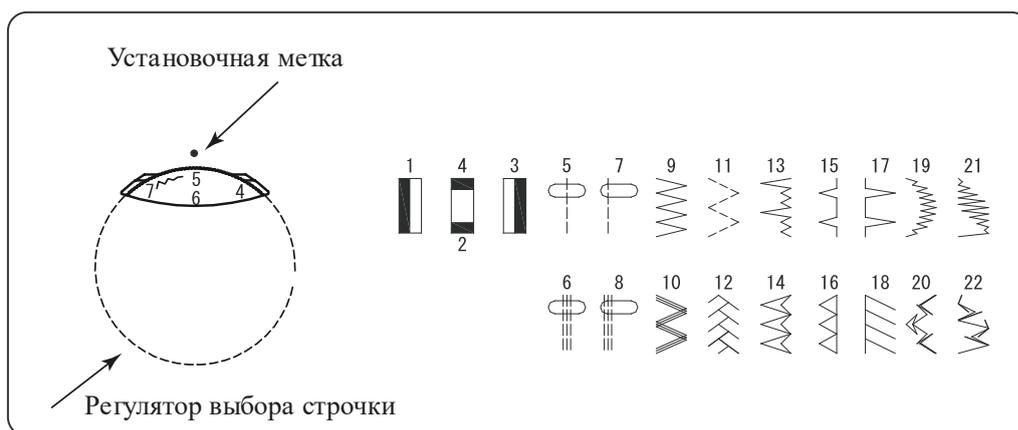
Регулятором выбирается не только вид строчки, но и ширина зигзага в диапазоне от 9 до 7. При переключении регулятора выбора строчек игла обязательно должна быть поднята вверх. Для выполнения строчек нижнего ряда (эластичные строчки), установите регулятор длины стежка в положение +S.S.-
