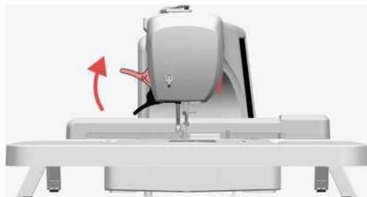
2. Слегка приподнимите пяльцы, отстегните и снимите их с каретки.
