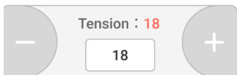
Электронная регулировка натяжения верхней нити: Нажмите на кнопку во время вышивания, чтобы установить необходимое натяжение.
