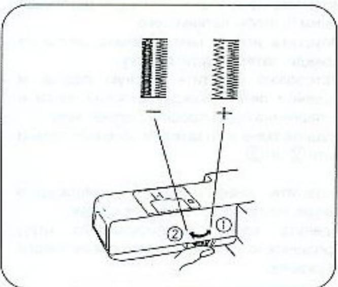
В случае, если частота стежков в петле слева и справа различна, снимите столик для принадлежностей и подрегулируйте баланс стежков.
