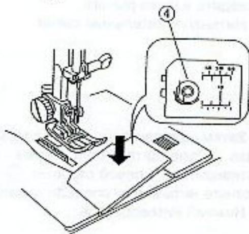
4 Вытяните примерно 15 см (6") нити и закройте челночную пластину.
