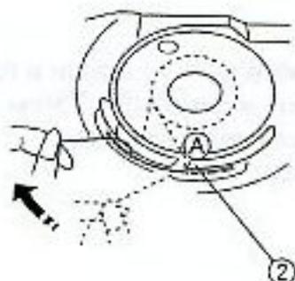
2 Заправьте нить в паз А на передней стороне шпулечного отсека. Протяните нить влево, через пружины нитенатяжителя.
