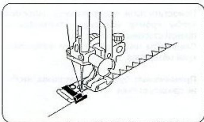
Стежок применяется для защиты обрезанных краев ткани от обтрепывания и для отделки края. Используйте лапку "C" с черным зубцом для направления края ткани.
