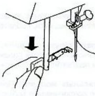
1 Поверните иглу в крайнее верхнее положение, поворачивая маховик на себя (для электронной модели нажмите кнопку). Оттяните ручку механизма продевания нити в иголку в крайнее нижнее положение.
