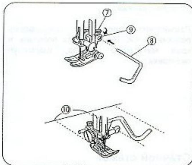
Направительная линейка поможет ровно выдерживать линию шва при простегивании. Ослабьте винт на лапке. Вставьте линейку в отверстие так, чтобы получить желаемое расстояние между линиями стежков. Натяните винт. Прошейте, направляя линейку по предыдущей строчке.
