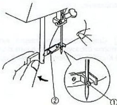
2 Поверните механизм в направлении показанном на рисунке 2. Проведите нить между треугольным выступом как показано на рисунке, затем проведите нить в паз над толкателем 1.
