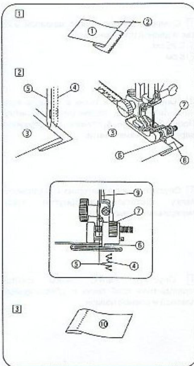
1 На грубых, обтрепывающихся материалах, сначала нужно обметать обрезанный край. На легких материалах обрезанный край может быть повернут внутрь и прижат. Подверните край вверх на желаемую ширину и подколите булавкой. Затем подверните край под материал, как показано на рисунке.
