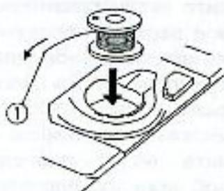
1 Расположите шпульку в держателе так, чтобы нить шла против часовой стрелки.
