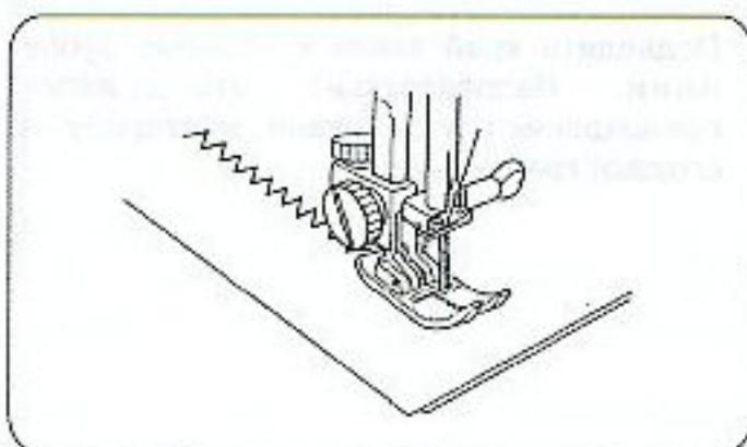
Шитье простым зигзагом широко используется для обметки, аппликации, пришивания пуговиц и т.д.
