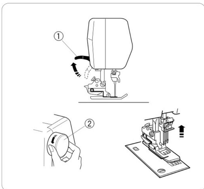
Поднимите рычаг прижимной лапки.
