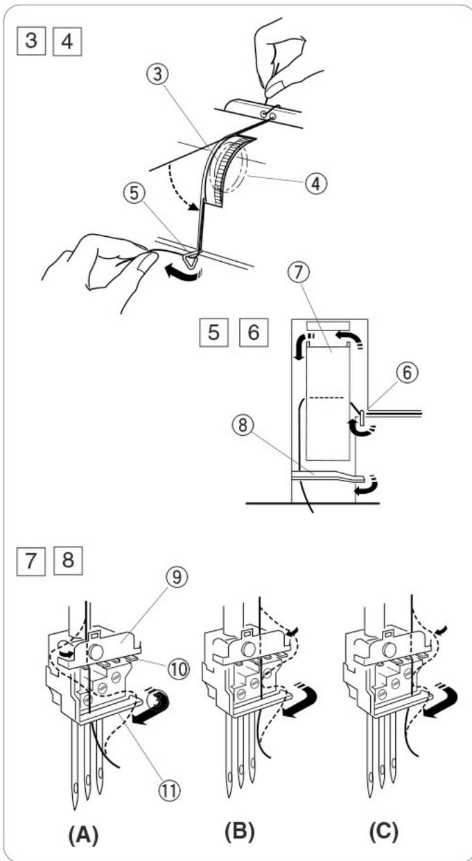
3 Удерживая нить с двух сторон, вставьте ее между дисками натяжения, немного натяните. (Поднимите рычаг прижимной лапки, тогда нить легко пройдет между дисками натяжения).
