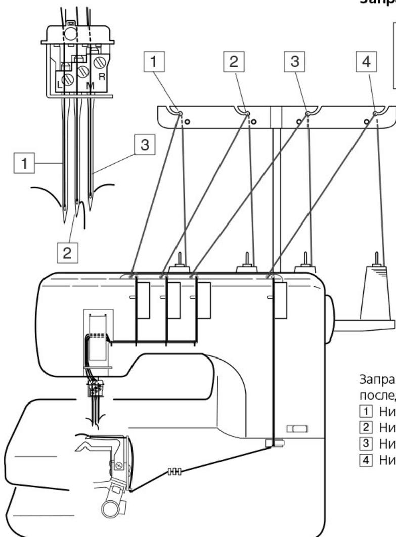
Заправляйте нити в машину в следующей последовательности:
