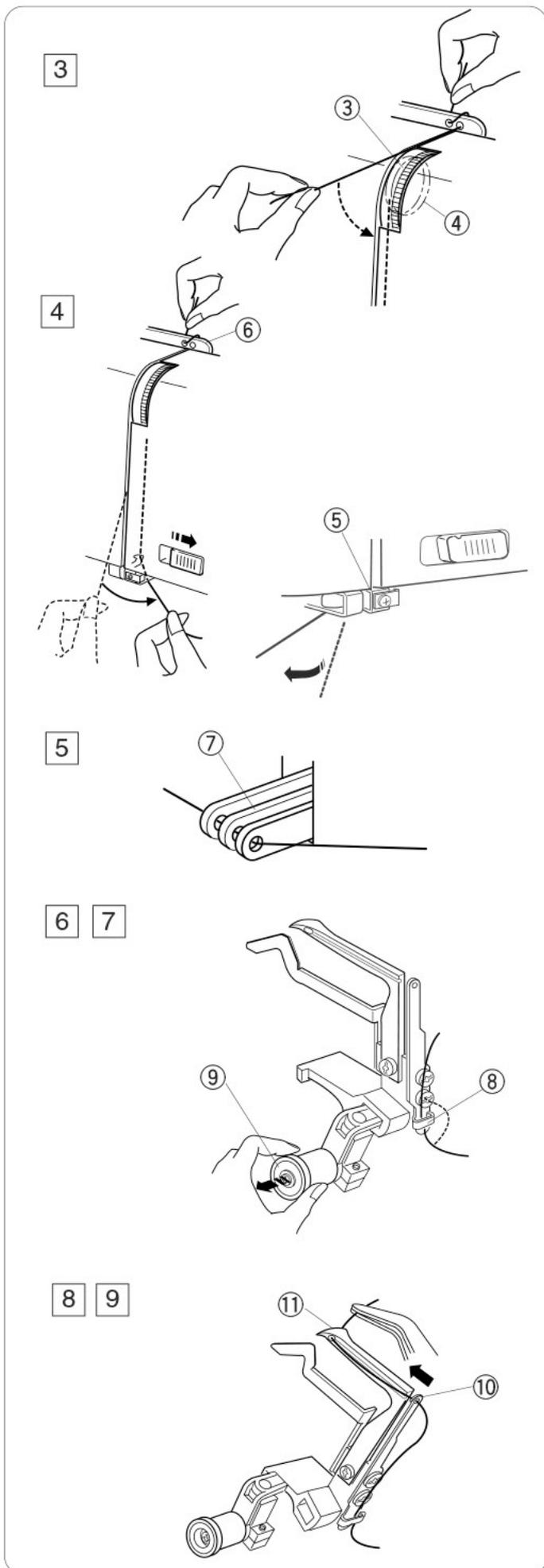
3 Удерживая нить с двух сторон, вставьте ее между дисками натяжения, немного натяните. (Поднимите рычаг прижимной лапки, тогда нить легко пройдет между дисками натяжения).
